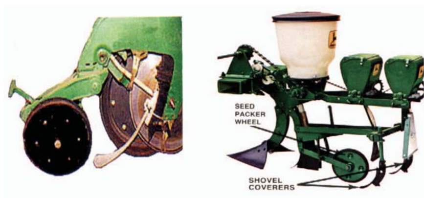
شکل ۳-۱۶- اشکال کلی تحکیم کننده های بذر، غلتکی (سمت راست) و لغزنده (سمت چپ)
