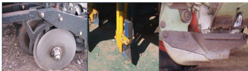
شکل ۳-۱۵- به ترتیب از راست به چپ، شیاربازکن کفشکی، شیاربازکن قلمی و شیاربازکن دو بشقابی
