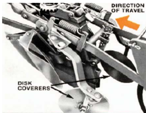
شکل ۳-۱۷- پوشاننده دو بشقابی که پس از شیار بازکن کفشی و پوشاننده لغزشی قرار گرفته است
