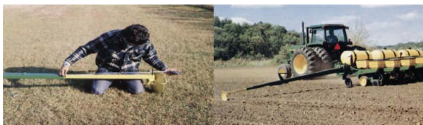
شکل ۳-۲۱- نشانگر ردیف کار و چگونگی تنظیم آن
