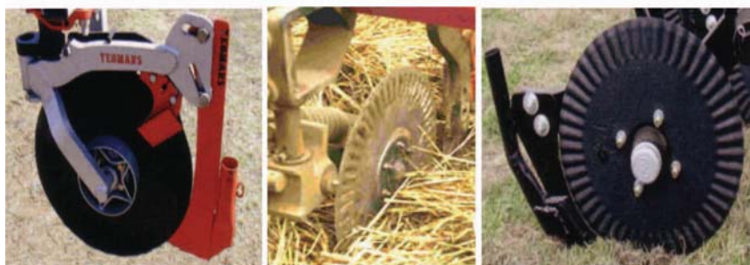
شکل ۳-۱۳ - پیش بر بشقابی شیاردار (راست)، پیش بر بشقابی شیاردار در حال کار (وسط) و یک پیش بر بشقابی صاف (چپ)
