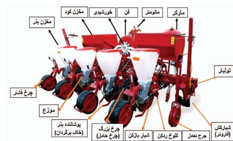
شکل ۳-۱۰- ردیف کار چهار ردیفه مناسب کاشت چغندر قند و قسمت‌های مختلف آن
