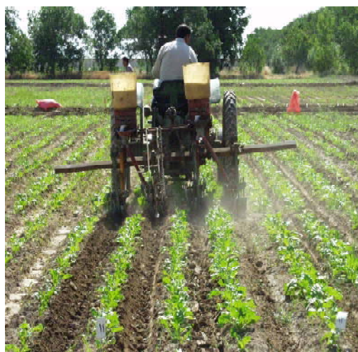
شکل ۱۶- مصرف کود نیتروژن سرک در زارعت چغندر قند با استفاده از دستگاه کود کار
