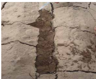
شکل ۲: ایجاد سله و شکاف در سطح خاک به دلیل بالا بودن درصد رس خاک
